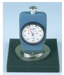
GS-744Gをスポンジシートに置いて、自重で硬さを測定します。発泡割合の分散性も判定できます。
