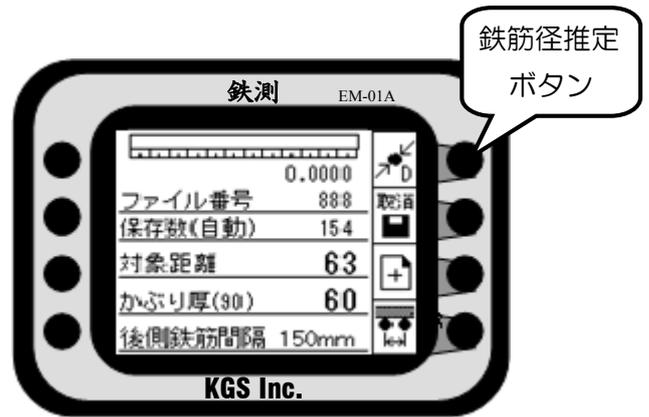
メッセージ終了後【推定鉄筋径初期化画面】にうつり、初期化を始めます。全ての○が●になると初期化終了で鉄筋径推定画面に移ります。
