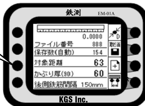
自動保存のときは、かぶり厚測定結果が更新されるたびに設定しているファイル番号に保存します。不要なデータが保存されたときは、最後の1つのデータを取消（F2）ボタンで削除することができます。
