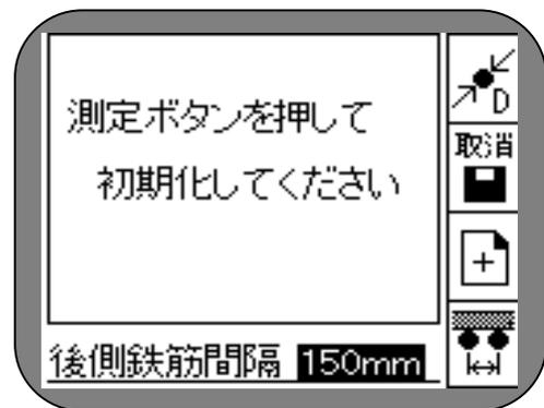
画面 25 後側鉄筋間隔設定変更画面
