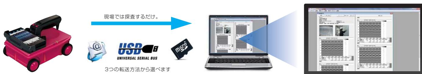
レポートメカ200はUSBキーを使用せずに起動した場合、レポートリーダとして動作し、レポートリーダはNJJ-200やNJJ-105で探査したデータの表示・解析を行うことができます。レポートリーダはUSBキーをお持ちでなくてもご使用頂けるので、発注者が速報で元データを受け取ったり、測定者がマークだけ打ち、速報として元データを提出したりと使い方は様々です。\*レポートリーダでご使用の場合、データの参照と一時的な変更は行えますが、保存ができないなどの機能制限をしております。
