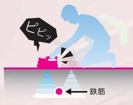
墨出しの際に、鉄筋の位置をブザーとLEDの点滅でお知らせ。鉄筋の見落としを軽減します。
