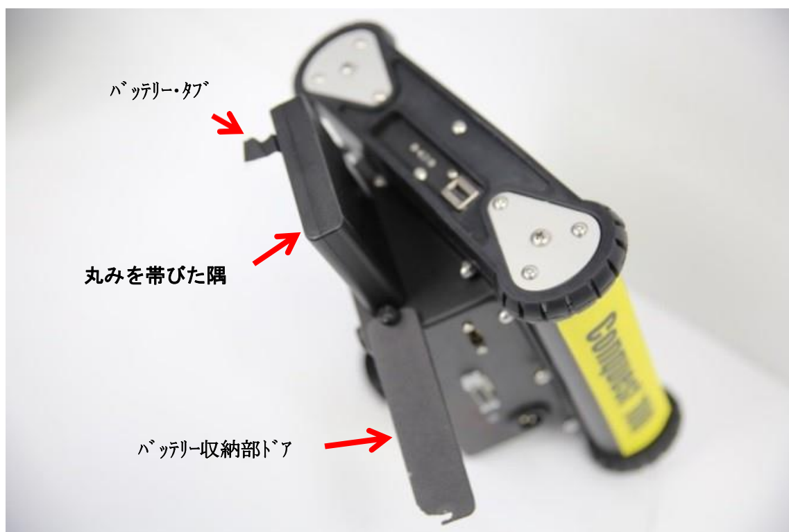
Fig. 3-6: 表示ユニットへのバッテリー装填。収納部は片側に丸みを帯びた隅が有り、バッテリー形状に適合しています。
