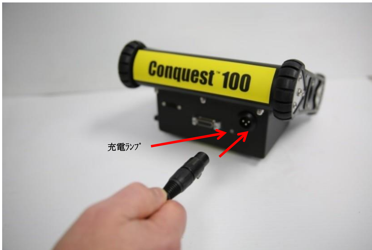
Fig. 3-7: バッテリー・チャージャー/ACアダプターの表示ユニットへの接続。コネクタ脇のランプが充電中はオレンジに、フル充電されるとグリーンに変わります。
