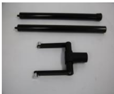
Fig. 3-9: センサ・ヘッドへのオプションのサイズ変更可能な延長ロットにより、立ち位置からのデータ収集が可能。
