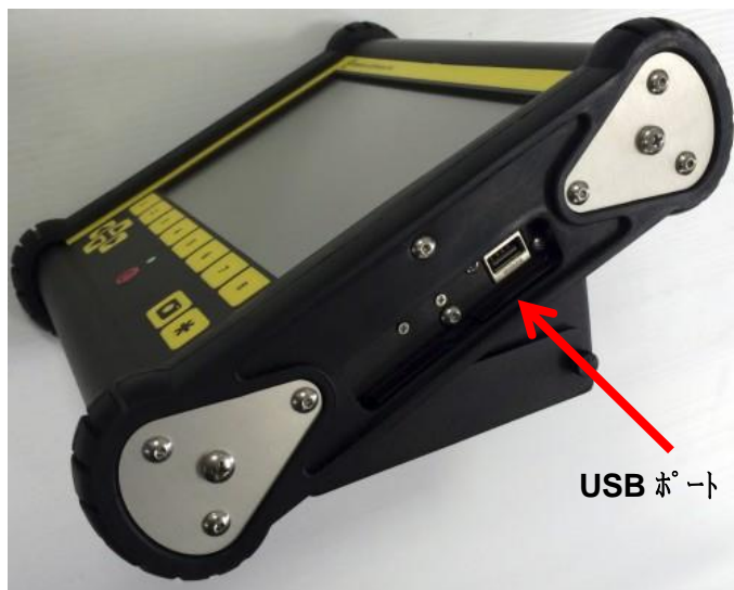
Fig. 3-15: 表示ユニットはデータ・転送ポート用の USB ポートを備えています。
