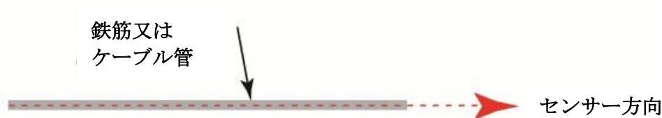
Fig. 2-5: 赤矢印は鉄筋又はケーブル管頂部上を走るセンサー経路
