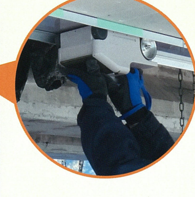
② PCT桁における磁束密度測定状況 (磁気計測ユニットを用いて)
