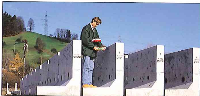
自動データ保存機構を有するプレハブコンクリート部材の連続試験
