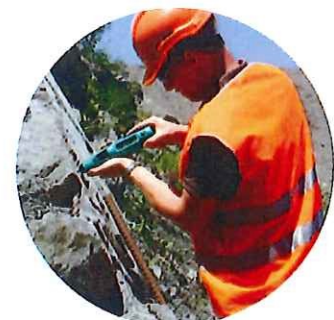
反発速度比(Q value)によるコンクリート評価 (ドイツの試験機関における反発速度比と強度との関係)
