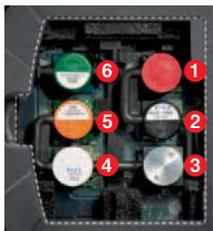
testo 350には、標準搭載のO<sub>2</sub>センサの他、1~5種のセンサ搭載が可能です。各スロットに搭載可能なセンサは、下記の表の通りです。
