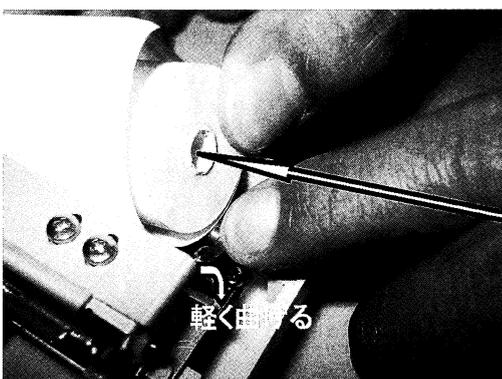
4. もう一方の軸受け部を指で軽く外側に曲げ、反対側の記録紙の芯にペーパーホルダの軸受け部を挿し込みます。
