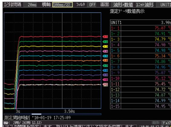
大型 (5.7 型 /640 × 480 ドット) の液晶ディスプレイを採用。多チャンネルの波形を観測しやすくなりました。
