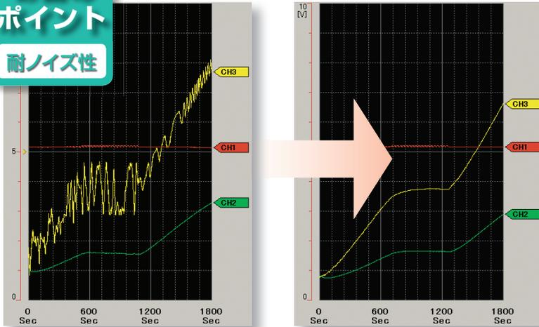
電磁調理器等の温度測定は、電気ノイズを処理できないと、このような波形になってしまいます
