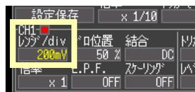
測定有効範囲は、電圧軸レンジの  $\pm 10$  倍までです。(50 V/div の場合は端子間最大定格電圧 DC400 V まで)
