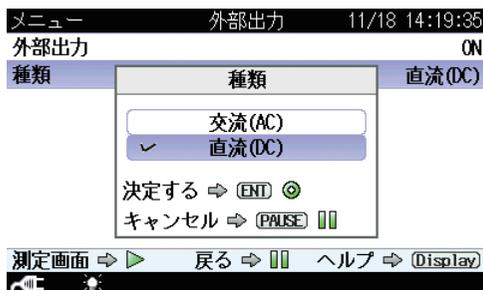
7. △/▽キーで外部出力の種類を [交流 (AC)] または [直流 (DC)] から選択して、MENU/ENTER キーを押します。
