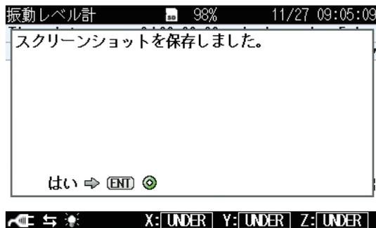
保存した画面データは、DISPLAY キーを押しながら  $\Delta/\nabla/\triangleleft/\triangleright$  キーの  $\Delta$  キーを押すことで、画面に表示できます。画面データ表示中に  $\Delta$  キーを押すと、表示するデータが切り替わります。DISPLAY キーを押すと表示を終了します。
