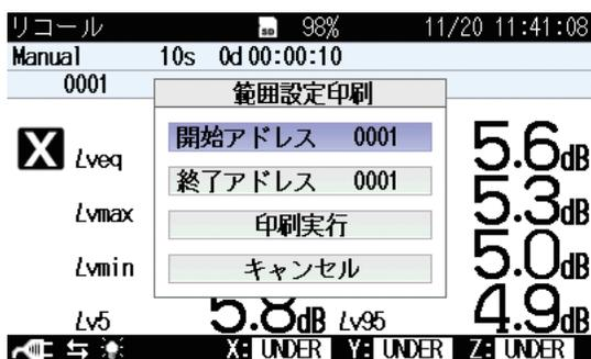
8. 開始アドレスと終了アドレスを設定後、[印刷実行] を選択して、MENU/ENTER キーを押します。設定したアドレス範囲のデータが印字されます。
