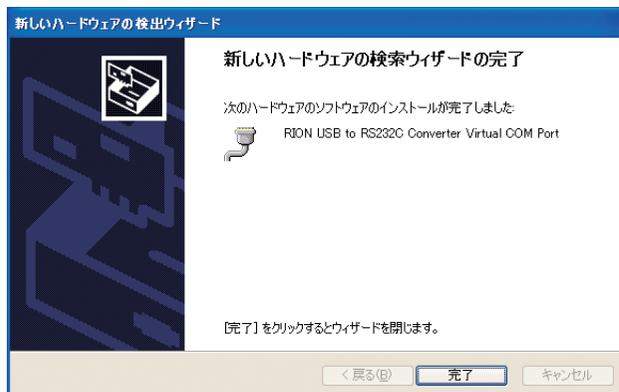
ドライバのインストールにより、コンピュータに仮想 COM ポートが作成されます。仮想 COM ポートの確認方法は、次ページの「仮想 COM ポート確認」を参照してください。
