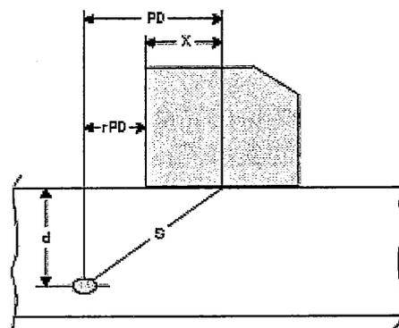
斜角探触子の場合、ビーム路程の次の入射点までの区間 **L** も算出することができます。この区間 **L** の測定値は、**La**、**Lb**、**Lc** として表示できます。
