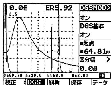
測定ラインには、ビーム路程  $S$ 、DGS 線図に対するエコー高さ (dB)、きずエコーの等価反射源の大きさ (ERS)、校正レンジが表示されます。
