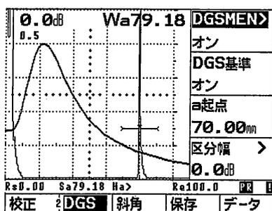
一般的な DGS 線図に基づいて、3 mm の曲線を画面の高さ最大 80% で表示するための探傷感度が算出されます。このとき、ゲインは「0.0dB」に設定されます。その後ゲインを変更すると、それに応じて曲線が変わります。
