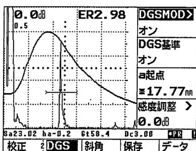
横穴も基準エコーとして使用できますが、使用する波長の1.5倍以上の直径、近距離音場の1.5倍の距離が必要です。これらの条件に合致していなければ、エラーメッセージが表示されます。
