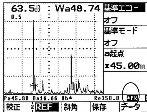
基準エコーが記録され、測定ラインに「R」が表示されます。
