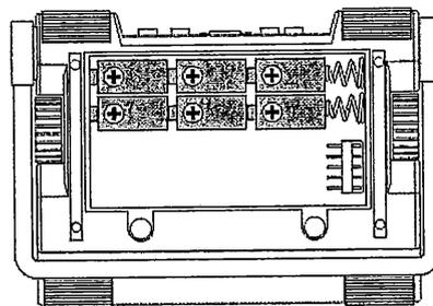
④バッテリーコンパートメントの蓋を閉め、ネジで止めます。
