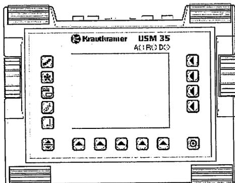
USM 35X の周波数帯域は 0.5 ~ 20 MHz、最大校正範囲は 10 m (鋼中) で、大型構造物の測定や高精度測定に適しています。また、小型でありながら豊富な機能を持ち、多用性と携帯性を兼ね備えています。
