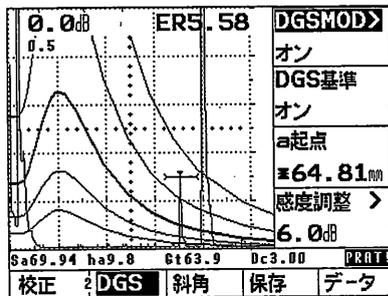
これにより、DGS 線図はエコーの減衰による影響を反映します。エコーの減衰を補正すると、測定ラインに「A」が表示されます。
