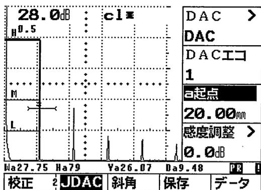
⑦ 次の基準エコーをピークにして同じ手順を繰り返し、曲線上の次の点を記録します。記録を行うたびに、DACEHO/DAC エコの数字が1ずつ大きくなります。
