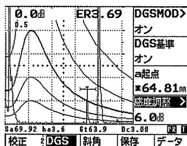
上図の例では、表面の粗さを補正するため、探傷感度が 6 dB 上がります。左側のエコーが 6 dB 高くなり、ERS 3.2 で評価します。測定ラインには「T」が表示されます。
