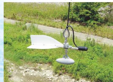
\*内訳(羽根、重り(約1.3kg、約2.5kg)、吊り下げ金具、シャックル2個、スイベル)
