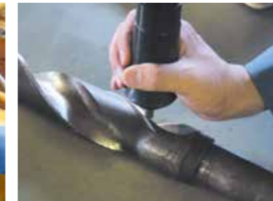
ドリルの刃先の硬さ測定
