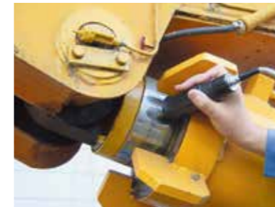
硬さ測定による経年変化の診断
